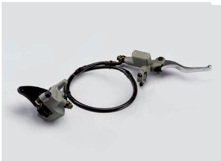
KIT FREIN AVANT HYDRAULIQUE YCF 50 2020 (ADAPTABLE SUR LES YCF 50 2012-2019)
